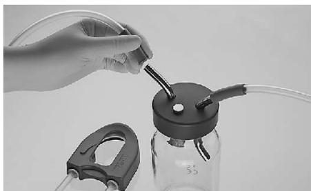
3. 将泵的软管套件短小末端与吸引瓶连接，并将标有“waste”（垃圾）字样的另一端连接至收集器上。
